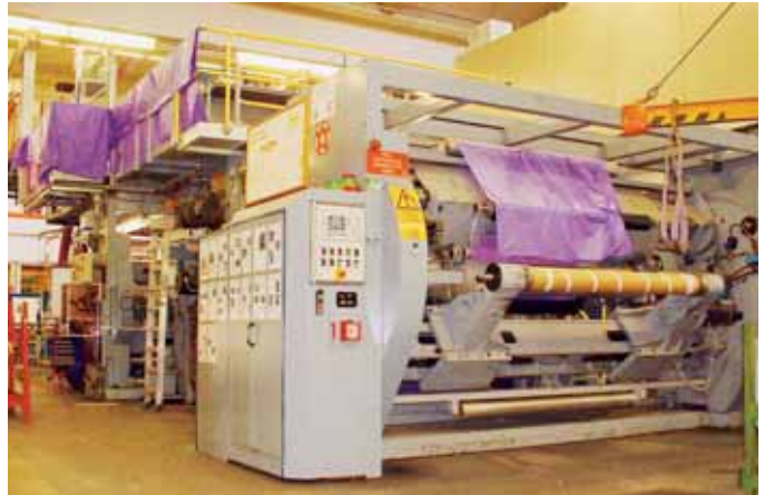
Abb. 1: Die 30 Jahre alte Flexodruckmaschine des Typs Olympia 1475 von Windmüller & Hölscher brachte der Lenze-Anlagenbau in kürzester Zeit auf den Stand der Technik.
